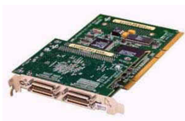
Рис. 14. Адаптер системной сети SCI N335, выпускаемый ОАО НИЦЭВТ
