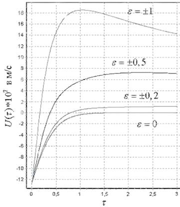
Рис. 1. Зависимость радиальной составляющей скорости элементов кольца от значений параметра  $\varepsilon = 0, \pm 0,2, \pm 0,5, \pm 1$
